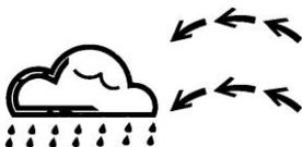
Le seuil d'orage peut être configuré pour s'adapter aux besoins de prévisions orageuses de l'utilisateur ; ce seuil est réglable de 3 à 9hPa (le réglage par défaut est de 4hPa). Lorsque la pression atmosphérique passe sous le seuil déterminé dans une période de 3 heures, l'icône de nuages avec pluie ainsi que les flèches de tendance se mettront à clignoter pendant 3 heures pour vous avertir que l'alerte orage a été activée.
